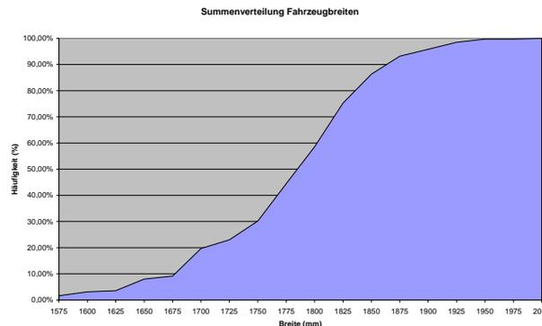
Die Summenverteilung der Fahrzeugbreiten der aktuellen Zulassungen macht deutlich, dass eine Fahrzeugbreite von 1,75 m, wie sie von der EAR 05 bei dem Bemessungsfahrzeug angesetzt wird, nur von 30% der aktuellen Neuzulassungen eingehalten wird. Die Fahrzeugbreite, die von 85% der Fahrzeuge eingehalten wird, liegt bei 1,85 m der aktuellen Neuzulassungen.
